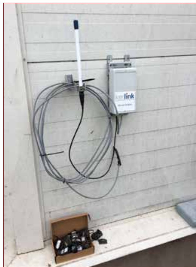
A Rárapordányba telepített LoRa adatgyűjtő és továbbító berendezés. Kis helyigénye miatt nem okoz gondot a felszerelése. Működtetéséhez tápfeszültség biztosítására van szükség.
